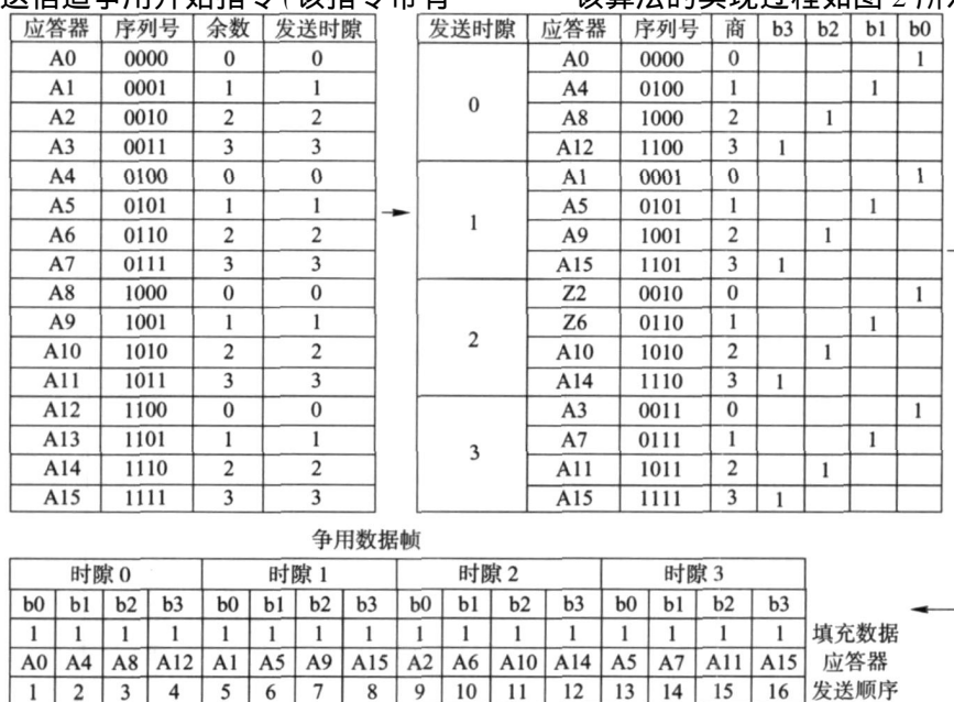
图2 基于序列号对时隙数运算的排序算法演示
