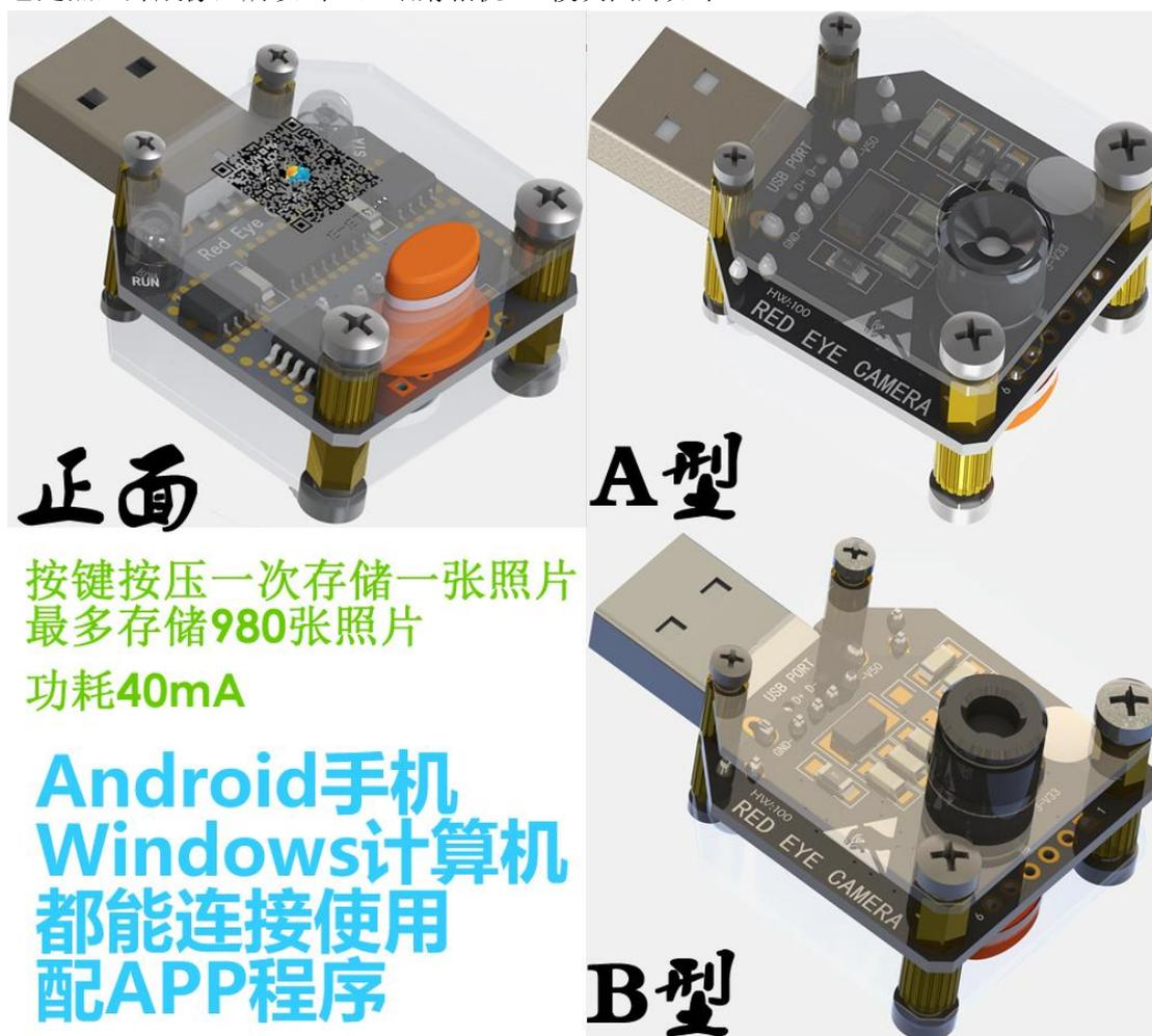
Red Eye Camera (以下简称“IDF-x”或“设备”) 是基于红外阵列高精度温度传感器以及先进软件算法的非接触式热成像仪器, 可对视场范围内任何物体进行红外成像, 成像分辨率 512\*384 像素, 温度灵敏度 0.1°C, 绝对精度 ±1.5°C, 刷新频率最高 64Hz。自带存储和实时时钟, 具备数据实时输出显示、拍照存储功能, 数字接口包括 UART 和 USB, 可直接连接
